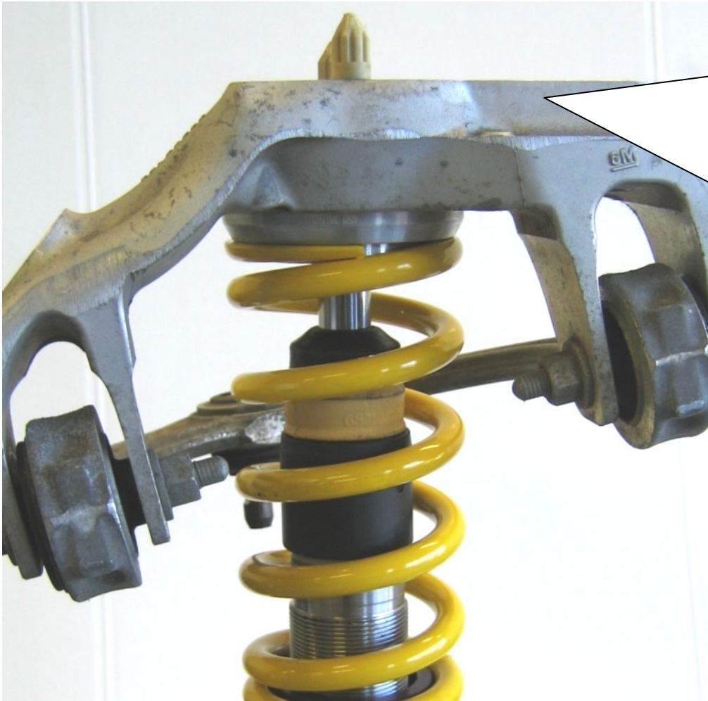
Ansicht Stützlagereinheit oben Top view supporting bearing unit
